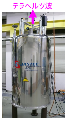
20 T超伝導マグネットを用いた 1 THz / CW ジャイロトロン
