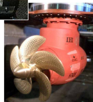
開発したモータを収納したポッド
