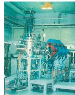
200kV イオン注入装置
