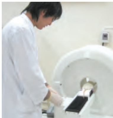
全身用PET装置： 臨床検査や臨床研究で、ヒトのイメージングに用います。
