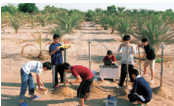
土壌からの水分蒸発量を調べるための気象ステーションを設置
