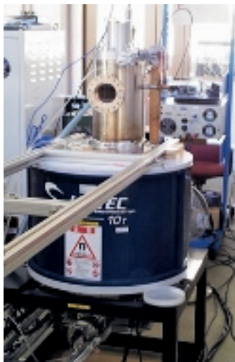
A photo of a recently developed gyrotron. 最近開発した高性能ジャイロトロンの写真。
