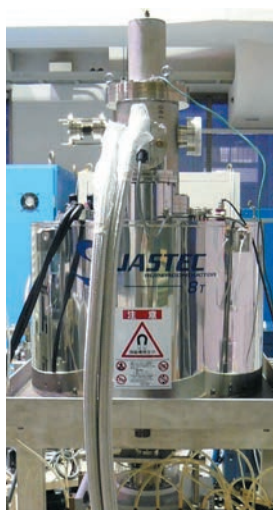
The cross-section and photo of a recently developed gyrotron. 左は最近開発した高性能ジャイロトロン断面図及び写真。
