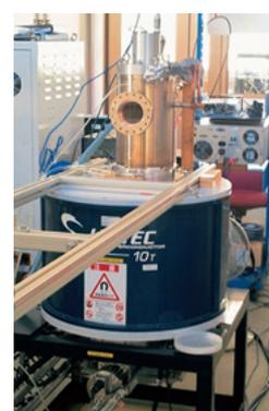
電磁波発生装置「ジャイロトロン」
