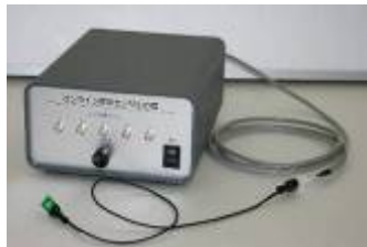
オンライン摩耗センサとその計測システム 軸受やクラッチ・ブレーキライニングなどの しゅう動部材の摩耗程度を分解せずリアル タイムで検出できるセンサ
