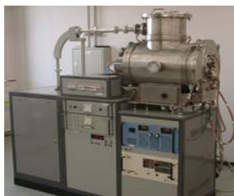
24 GHz/2.5 kW 高出力電磁波照射装置
