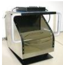
近視者でも裸眼で顔が見える電子全顔鏡 CCDカメラ・液晶ディスプレイ・ハーフミラー を組み合わせた、近距離で遠方からの顔 全体の映像を見ることができる電子鏡
