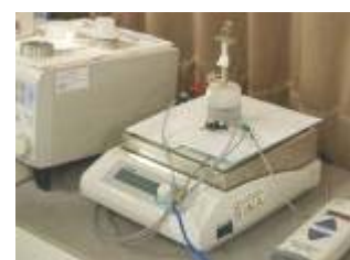
非水系電解用三電極化学測定セル 大規模な電池作製設備のない場所 においても利用できる三電極式の電池 試験セルとそれを用いた評価システム
