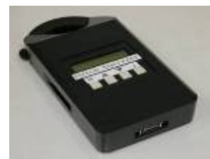
色相判別装置の試作開発 物質の色を迅速かつ精度よく測 定できる安価な色相判別装置
