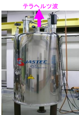
20 T超伝導マグネットを用いた 1 THz / CW ジャイロトロン
