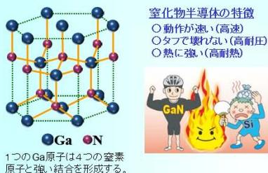
情報機器や家電機器の省エネ性能を向上できる新しい半導体として窒化物半導体の活用が注目されています。その代表は窒化ガリウム(GaN)です。これまでのシリコン半導体より、高速動作、高電圧動作、高温動作に適しています。
