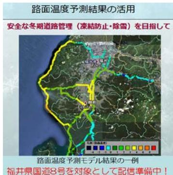
図3. 福井県内国道8号の路面温度変化を示したマップである。現在は路面の滑り摩擦係数  $\mu$  を示す前段として、数時間から1日先の路面温度の路線変化を道路管理者に配信すべく準備中である。これにより、凍結防止剤の散布や除雪車の配備に関する科学的な判断材料の提供が可能になる。
