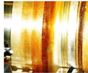
発電所のタービン軸に付着した潤滑油の劣化物
