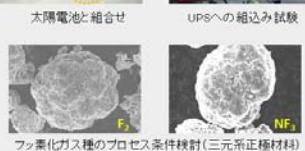
フッ素化ガス種のプロセス条件検討（三元系正極材料）
