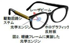
図2. 眼鏡フレームに実装した光学エンジン
